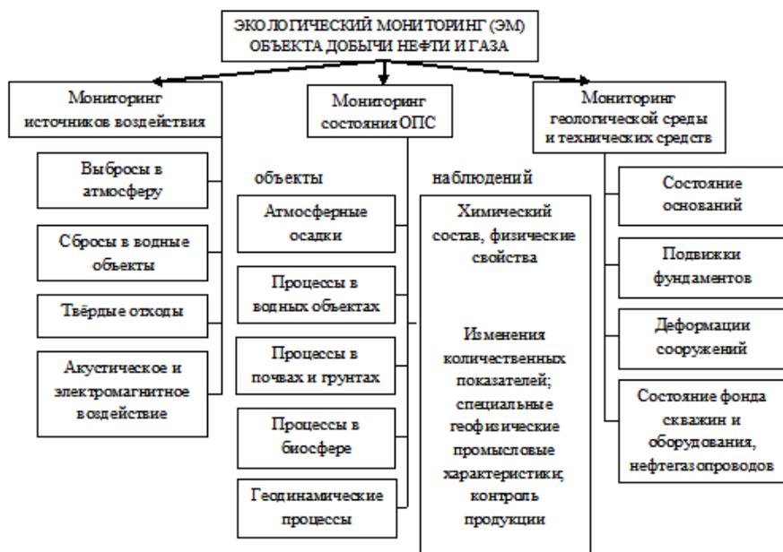
Рис. 1. Общая структура экологического мониторинга объекта добычи нефти и газа
