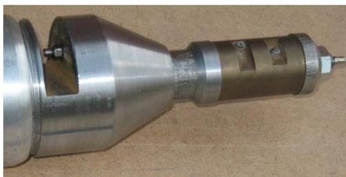
Рис.1. Ротационный вибратор, совмещенный со струйным насосом
